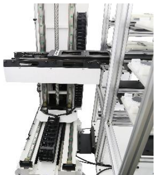
堆垛升降机上料立库 自动拿取工件托盘
