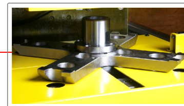
工件固定装置及旋转平台
