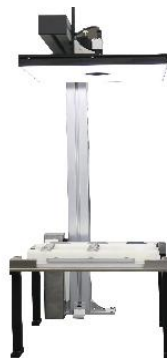
视觉定位平台自动 对工件摆放位置进行确认
